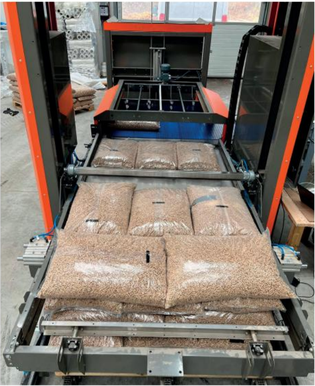
/ 3. Ein Palettierer, der Säcke automatisch auf einer Palette platziert, minimiert den Arbeitsaufwand des Bedieners beim Einsammeln der Paletten
