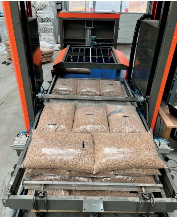
/ 3. Un palettiseur qui place automatiquement les sacs sur une palette minimise le travail de l'opérateur pour collecter les palettes
