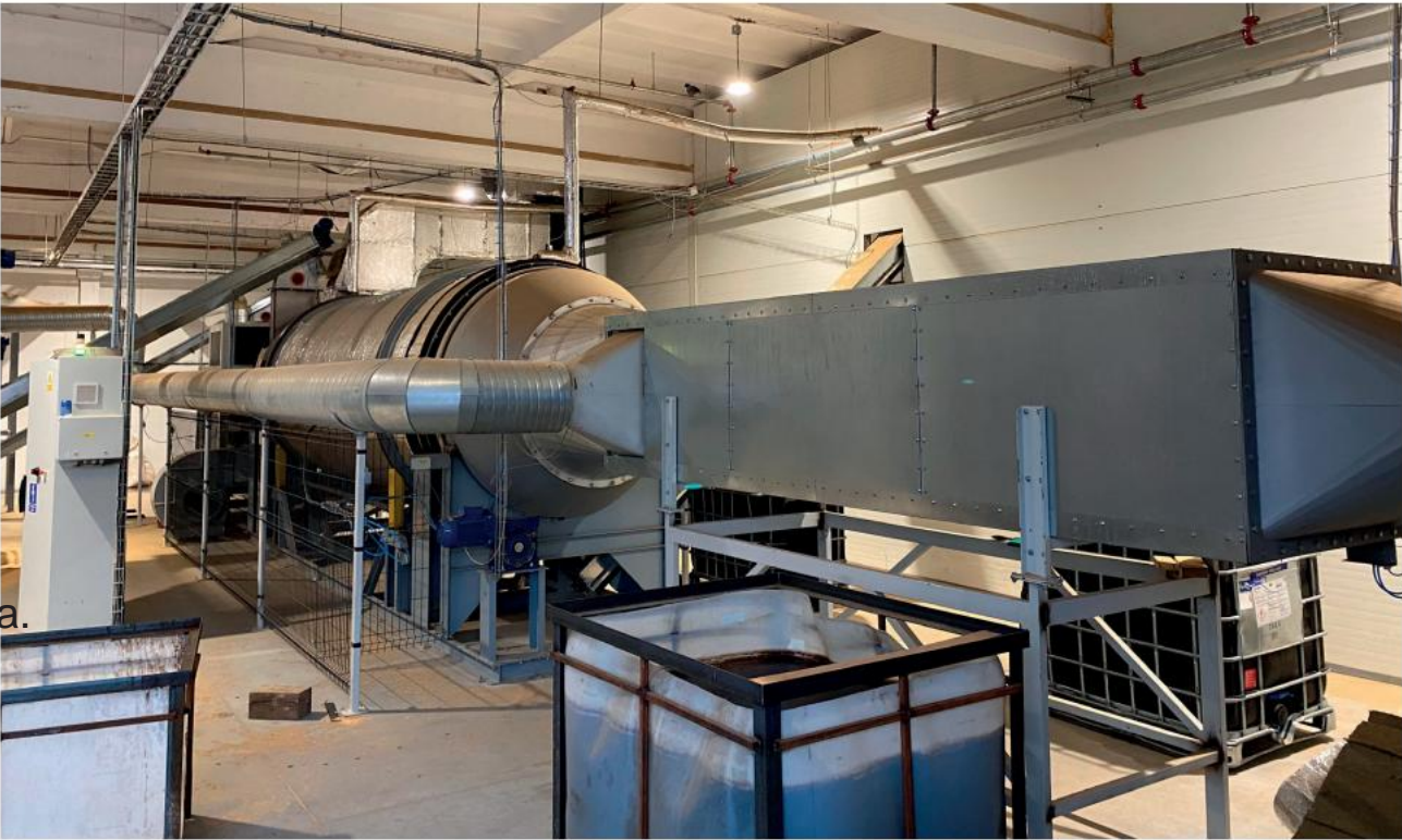
/ 2. Recuperatore che recupera 200 kW di calore alla temperatura di 170°C
