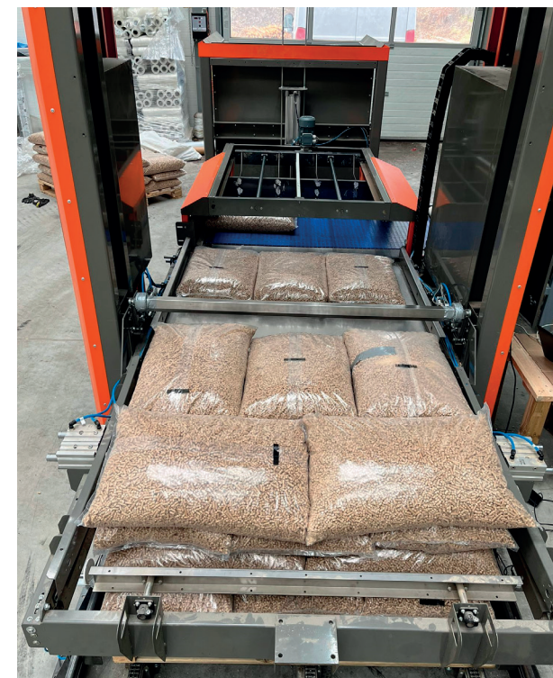
/ 3. Paletyzator automatycznie układający worki na paletę minimalizuje pracę operatora do odbioru palet
