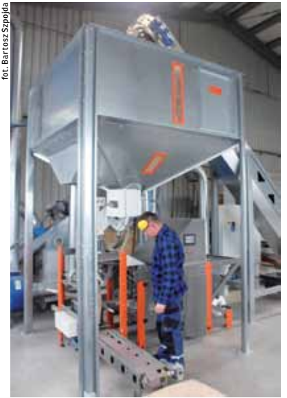
Jednym z udogodnień w linii od Labora.Energy jest pakowarka peletu, dzięki której całą linię obsługuje jeden pracownik.
