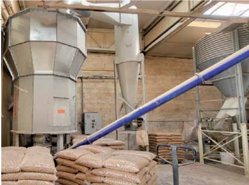
Meble Pieprzyk postawiły na produkcję pelletu za sprawą linii od Labora.Energy, by sprostać własnemu zapotrzebowaniu na ekologiczny opał. Z lewej strony widać suszarnię Eco Air Dryer zasilaną ciepłem odpadowym z kotłowni.
