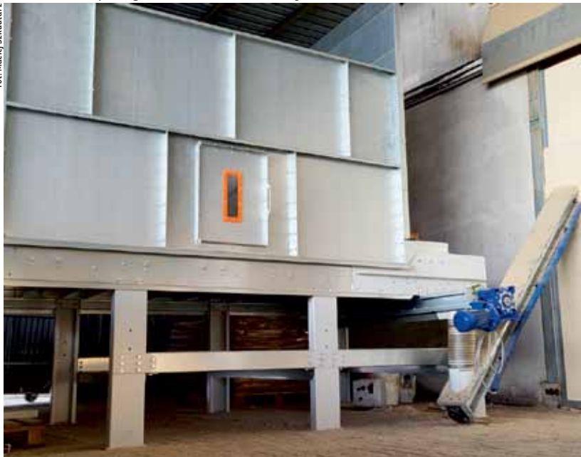
Bufor (ruchoma podłoga 15 m³) suszarni Eco Air Dryer.
