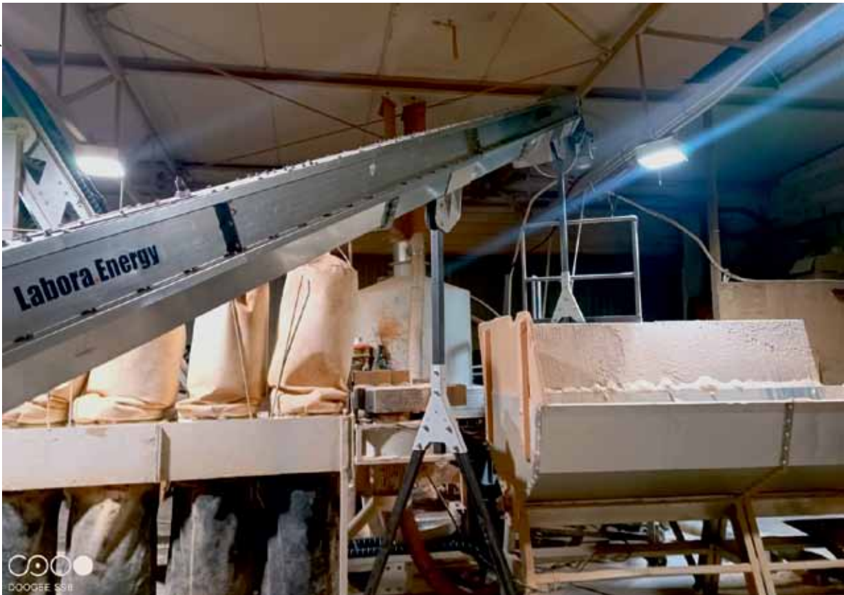
Pellet, który powstaje na linii, produkowany jest wyłącznie z wysokojakościowych trocin pozostających podczas produkcji mebli z drewna litego. Na zdjęciu widać ślimak rozładowniczy o długości 9mb z suszarni Eco Air Dryer do bufora pelletciarki
