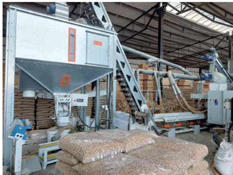
Linie peletujące od Labora.Energy są modułowe, dzięki czemu można dostosowywać ich wydajność do rozwoju firmy, zapotrzebowania rynku albo dostępności surowca.
