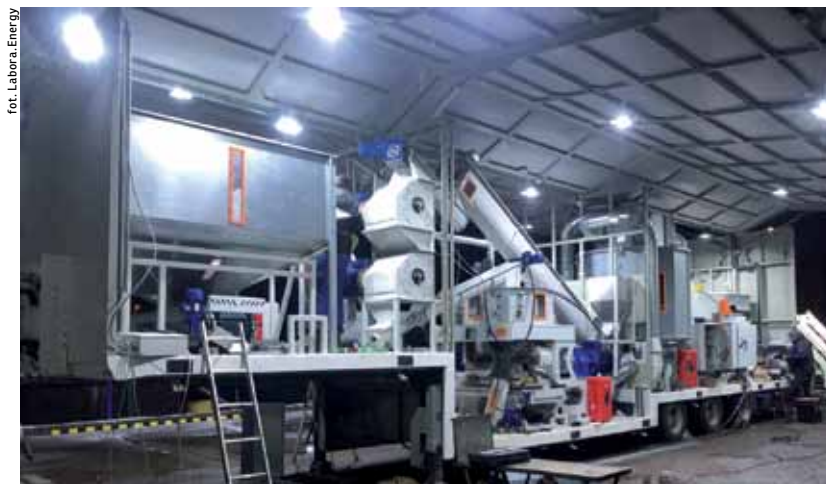
Eko Naczepa – mobilna odpowiedź na potrzeby klientów w zakresie produkcji pelletu.
