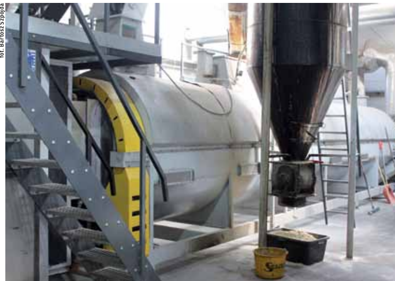
W przypadku firmy Tarskol, gdzie do produkcji pelletu używany jest materiał suchy i mokry, najsensowniejszym rozwiązaniem było wykorzystanie suszarni rewolwerowej.
