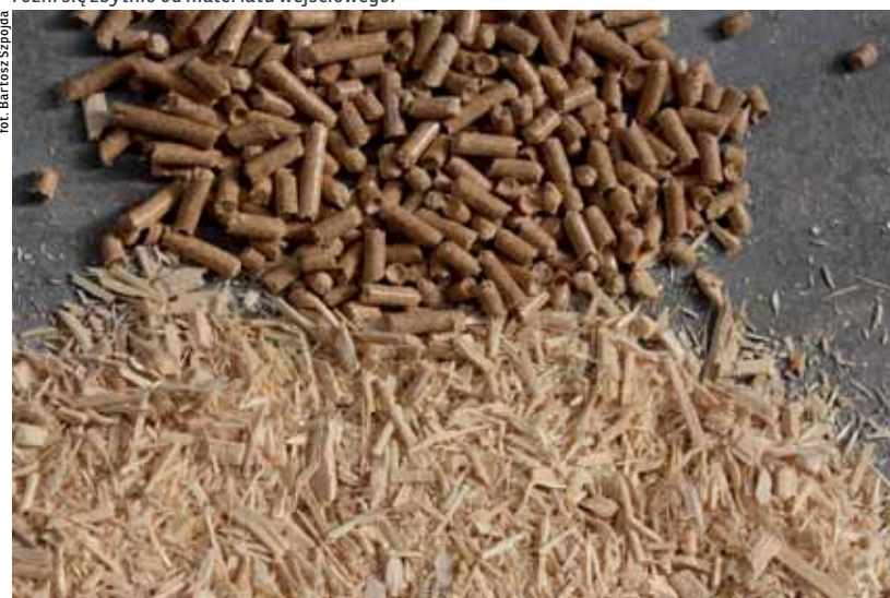
Wysokojakościowy pellet nie może zawierać zanieczyszczeń, musi być zwarty i w kolorze, który nie różni się zbytnio od materiału wejściowego.
