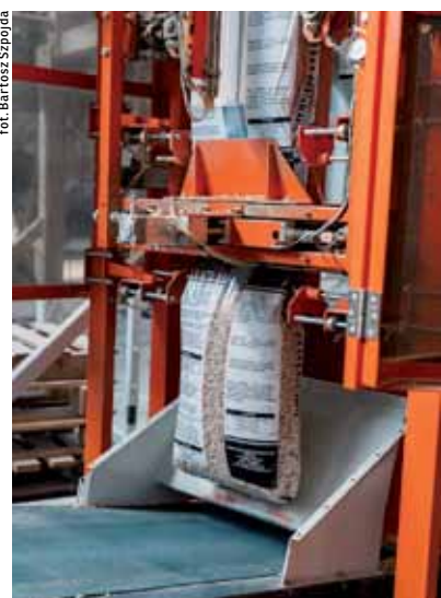
System automatycznego pakowania pelletu w worki oszczędza czas i pozwala na bezproblemowe magazynowanie towaru gotowego do sprzedaży.
