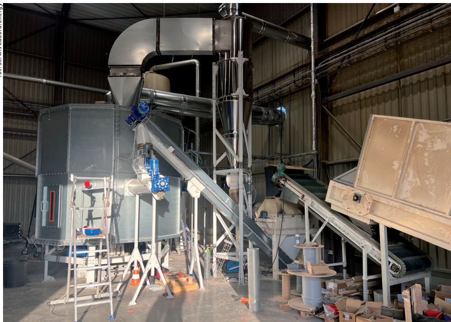
Kluczowym elementem modernizacji było udoskonalenie systemu chłodzenia gotowego produktu, dzięki czemu klient we Francji osiągnął znaczną poprawę parametrów jakościowych wytwarzanego pelletu.
