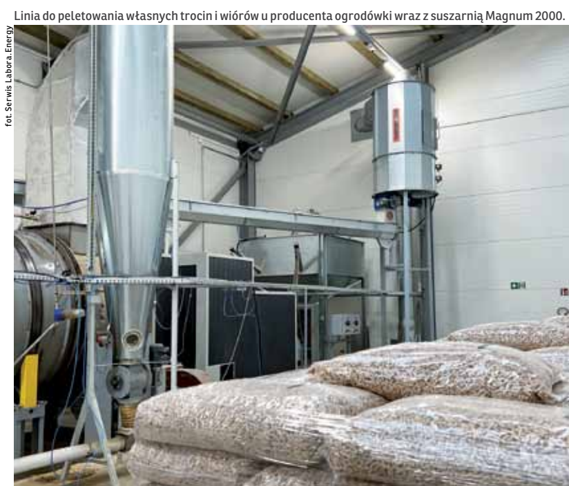
Linia do pelletowania własnych trocin i wiórów u producenta ogrodniki wraz z suszarnią Magnum 2000.
