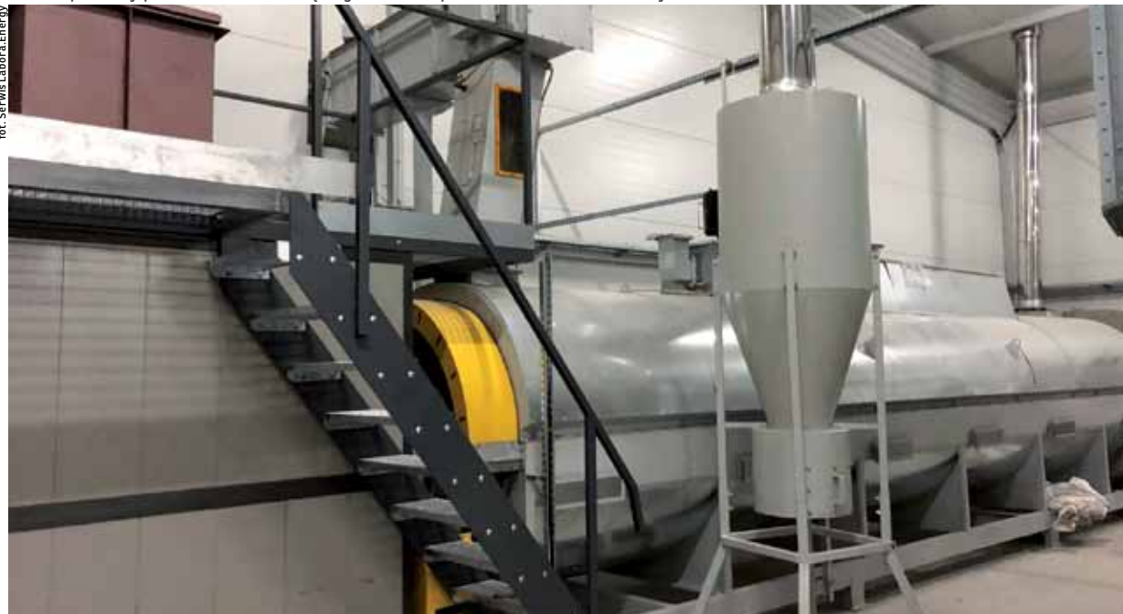
Linia do produkcji pelletu wraz z suszarnią Magnum 1500 u producenta kantówki okiennej.
