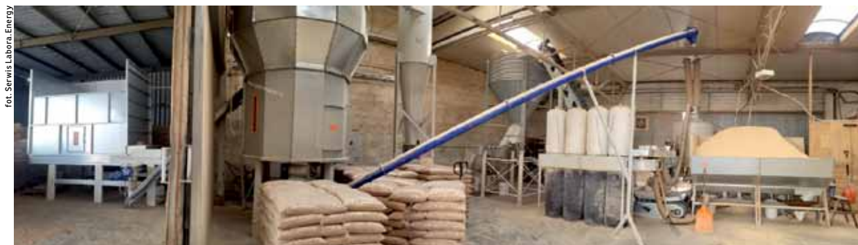
Eco Air Dryer zasilana ciepłem z kotłowni Klienta może być zintegrowana z linią do produkcji pelletu.
