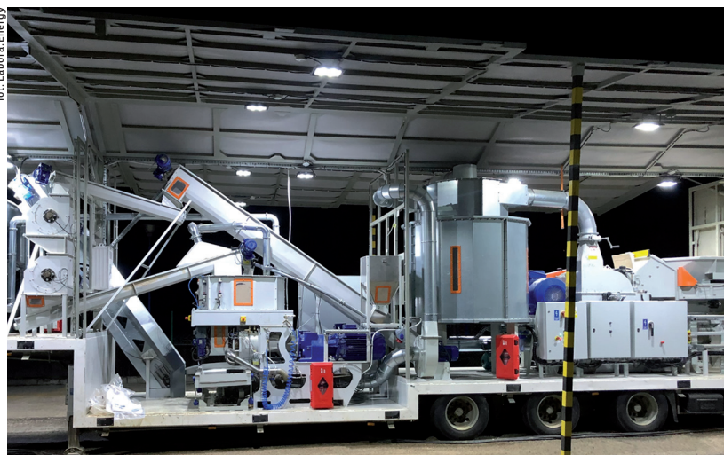
Serwis Labora.Energy opracowała także mobilną linię Eko Naczepa – jest to w pełni zautomatyzowana fabryka pelletu umieszczona na naczepie ciągnika siodłowego.
