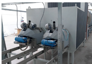
Palniki na pelet - zużycie paliwa tylko 132 kg/t suchego surowca.
