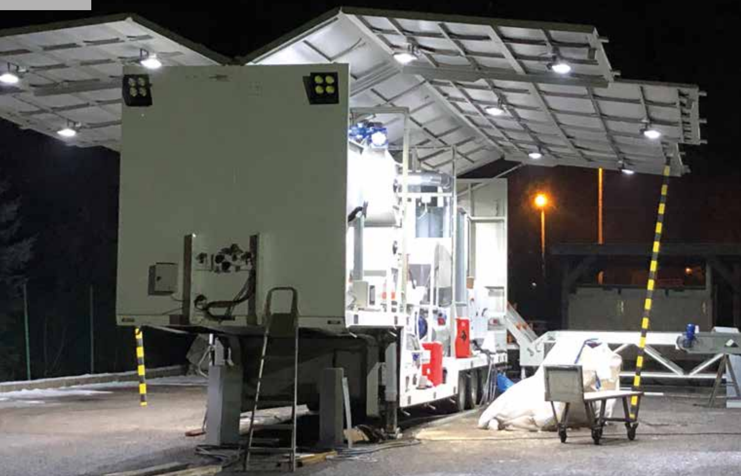
/ Cała fabryka jest ustawiona na naczepie, dzięki czemu można ją przetransportować w miejsce składowania surowca
