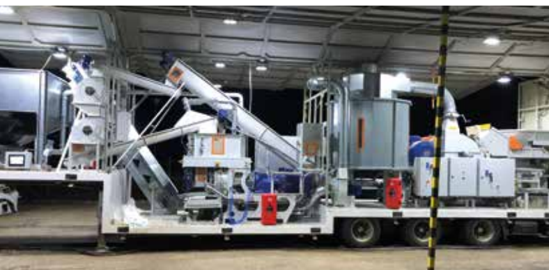
/ Cała fabryka jest ustawiona na naczepie, dzięki czemu można ją przetransportować w miejsce składowania surowca
