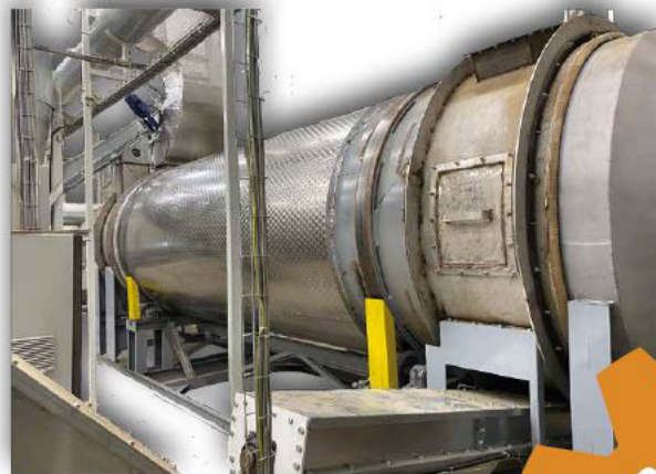
Suszarnia pofermentu typu Magnum przed adaptacją w celu wykorzystania spaliny z agregatu jako źródła ciepła
